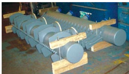
Figura 9. Duto de bocais do sistema de descarepamento primário
